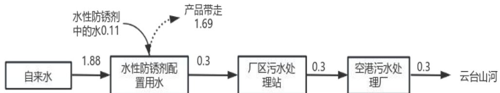
图 2-1 本项目水平衡图（单位 t/a）
