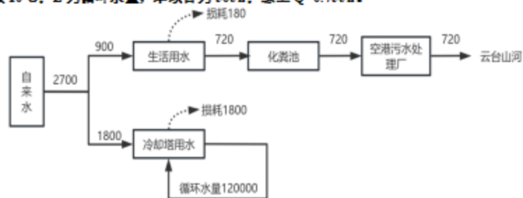
图 2-1 本项目水平衡图 (单位 t/a)
